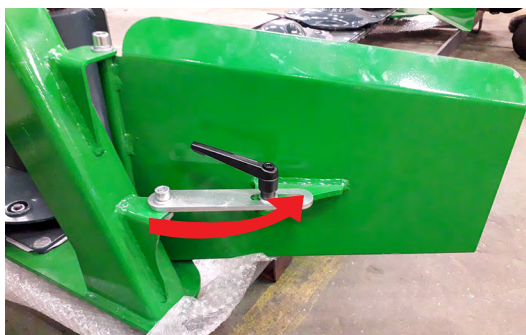
Montera fästet och skruva tillbaks handtaget. Upprepa momenten även på höger sida om rotorslåttärn.
