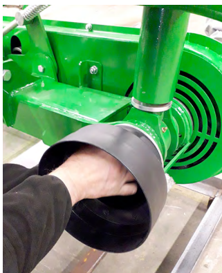
Montera fästet och skruva tillbaks handtaget. Upprepa momenten även på höger sida om rotorslåttärn.
